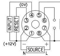
注:若配合近接开关(PNP型)或光电开关时,请将(+)接至1脚,(-)接至3脚,(OUT)接至4脚。
